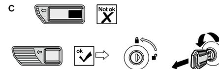
c, Assurez-vous que le bouton est dans sa position d'origine. Verrouillez le couvercle du coffre de toit en tournant la clé dans le sens inverse des aiguilles d'une montre et retirez la clé.
