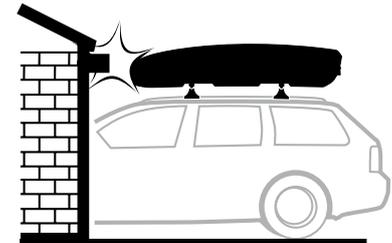
Attention, lors de stationnements dans des lieux fermés, le coffre de toit se trouve sur le toit du véhicule et la hauteur totale est plus élevée.
