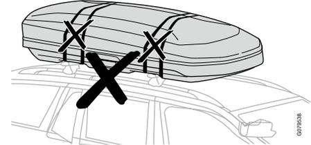
Gebruik nooit banden om het deksel te sluiten of de dakbox op de auto vast te zetten.
