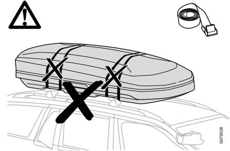
Niemals Gurte benutzen, um den Deckel zu schließen oder die Dachbox auf dem Fahrzeug zu befestigen.
