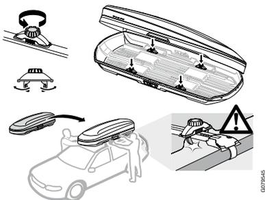
Desserrez les 4 attaches dans le sens inverse des aiguilles d'une montre
