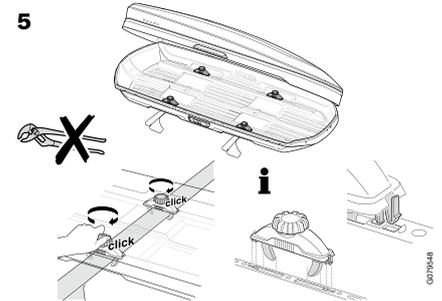
Sicherstellen, dass die Klemmen korrekt angebracht sind, siehe Abbildung
