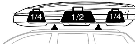
Ladung in der Dachbox immer sorgfältig verteilen. Die maximale Füllmenge der Dachbox beträgt **75 kg**.
