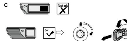
c, Controleer of de knop in de oorspronkelijke positie staat. Vergrendel het deksel van de dakbox door de sleutel linksom te draaien en verwijder de sleutel.
