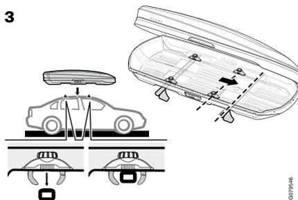
Assurez-vous que les attaches de verrouillage sont en place et que les barres de toit se trouvent entre les attaches de verrouillage.
