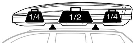
Répartissez toujours soigneusement la charge dans le coffre de toit. La capacité maximale du coffre de toit est de **75 kg**.
