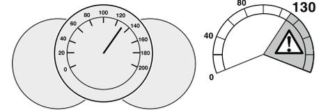
Overschrijd nooit de maximale snelheidslimiet als de dakbox is gemonteerd. De maximale snelheidslimiet is **130 km/h**.
