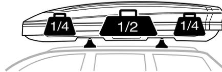
Verdeel de lading altijd gelijkmatig over de dakbox. De maximale capaciteit van de dakbox is **75 kg**.
