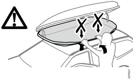
Vermeiden Sie es, sich am Rand der Dachbox festzuhalten, da dieser dadurch beschädigt werden kann.
