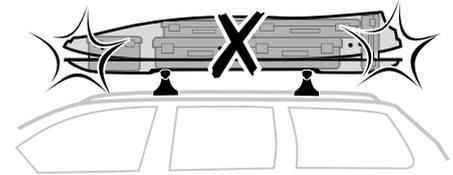
Wees bewust van het formaat van de bagage. Plaats nooit bagage in de dakbox waardoor het deksel niet goed sluit.
