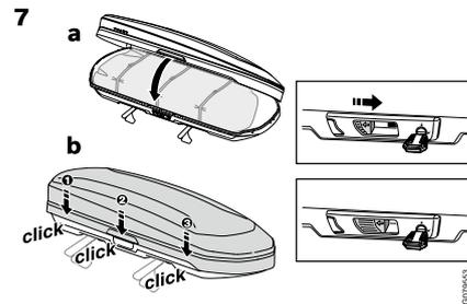
a, Deckel der Dachbox schließen
