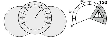
Die zulässige Höchstgeschwindigkeit niemals überschreiten, wenn die Dachbox montiert ist. Die Höchstgeschwindigkeit beträgt **130 km/h**.
