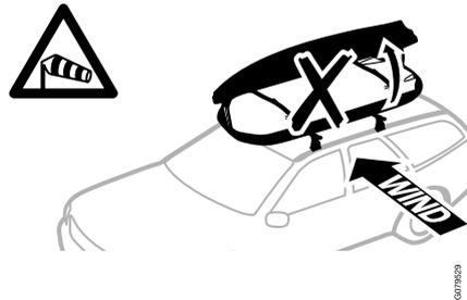
Stets sicherstellen, dass der Deckel korrekt geschlossen ist, da er sonst durch Seitenwind versehentlich geöffnet werden kann.
