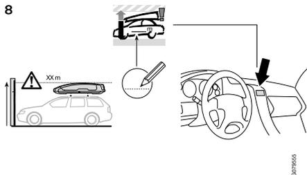
Mesurez la hauteur totale du véhicule et notez-la sur l'autocollant fourni.
