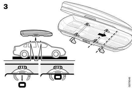
Sicherstellen, dass die Verriegelungsklammern vorhanden sind und sich die Dachträger zwischen den Verriegelungsklammern befinden.
