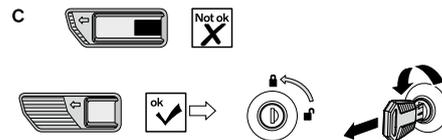
c, Sicherstellen, dass sich die Taste in der ursprünglichen Position befindet. Deckel der Dachbox verriegeln, indem der Schlüssel gegen den Uhrzeigersinn gedreht wird, dann den Schlüssel abziehen.
