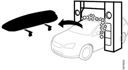
Vor dem Befahren einer automatischen Waschanlage ist die Dachbox vom Fahrzeug zu entfernen.
